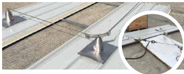
Testing av innfesting til sandwichelementer
